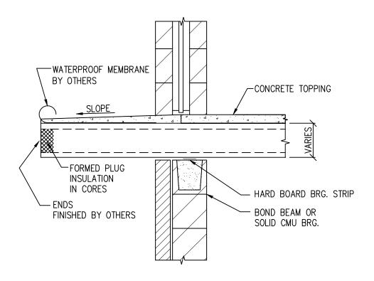
HOLLOWCORE CANTILEVER FLOOR PLANK
